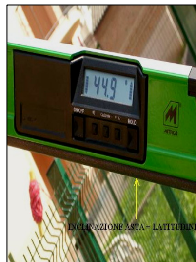
Fig. 27. Si sovrappone una livella digitale sull'asta/asse dell' Armilla per la verifica finale della sua corretta inclinazione, che dovrà risultare uguale alla Latitudine del luogo (Solero: Latitudine = 44.9°).
