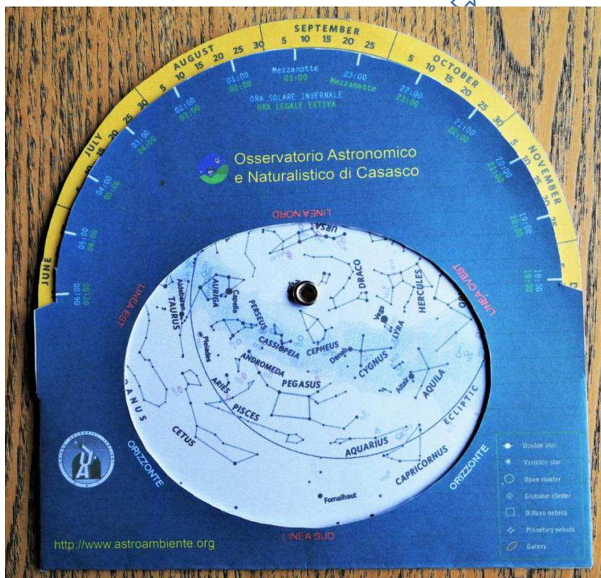
Fig. 34 - Complessivo finale Per l'utilizzo dello strumento, al fine di inquadrare la zona del cielo interessata, occorre far combaciare la data con l'ora, ruotando il foglio B. Ad es. il 25 Ottobre alle 21 (22 con l'Ora Legale, vedi Fig. 32), osserveremo la zona di cielo inquadrata dalla finestra dello strumento.
